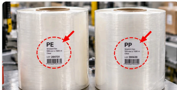
Dve roly, PE a PP, rozlíšite len podľa štítku
