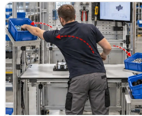
Vorher nach hinten greifen, in jedem Zyklus drehen
