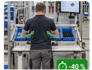
Nachher Behälter vor der Vorrichtung, Zyklus 40 % schneller
